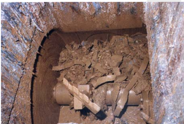
Widok pracującej mieszarki AVA o pojemności 10 m 3 : Odpady niebezpieczne podczas procesu mieszania, po obróbce przy pomocy nożyc obrotowych
